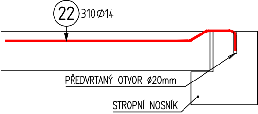
DETAIL "B" VĚNCE ZDIVA TL. 300 mm 166 bm; 44 ks PŘÍČNÝ ŘEZ M 1:25
